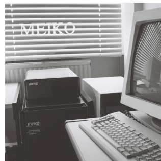
Meiko Computing Surface: 64 транспьютерных узлов с процессорами Intel i860
