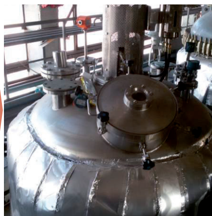
Образец реактора полимеризации этилена емкостью 1000 литров, имеющегося в распоряжении ВФ ИК СО РАН
