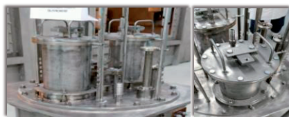
Макет электролизёра «металлизации» на 100 А в АО «ГНЦ НИИАР»
