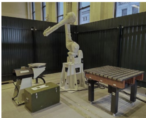
Рисунок 1. Макет установки прямой лазерной наплавки проволоки
