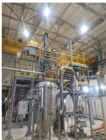
Рис. 1. Отечественная установка производства порошков титановых сплавов из прутков диаметром 80 и 120 мм
