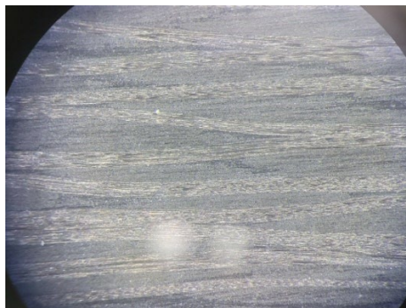
Рис. 1. Изображение поверхности углепластика, модифицированного УНТ «Таунит-М».
